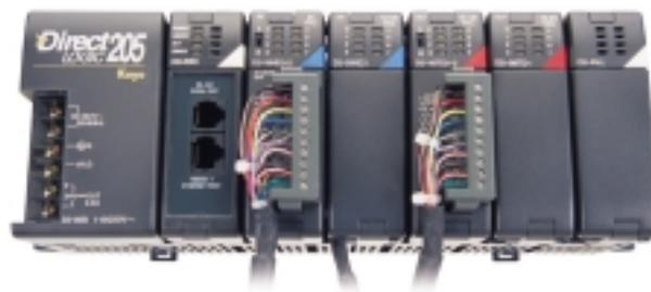
тели, выключатели, пускатели, датчики и т.д.) и обеспечивает интерфейс между процессорным модулем и информационными (входами) и управляющими (выходами) каналами.
