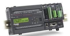
Широкий ряд моноблочных (от 14 I/O) и модульных контроллеров (до 3'584 I/O) **DirectLOGIC** от AutomationDirect (США), разработан известной японской компанией Кoyo Electronics, продукцию которой выпускали под своими торговыми марками ведущие производители PLC General Electric, Texas Instruments, Siemens, имеет самый высокий рейтинг среди производителей автоматике, и хорошо зарекомендовал себя во многих проектах в Украине.
