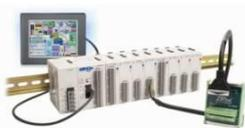
Новое семейство недорогих программируемых логических контроллеров (PLC) **CLICK** являются практичным решением в компактном исполнении с возможностью расширения (до 142 входов/выходов) и бесплатным программным обеспечением. Процессорные модули имеют до 3-х портов RS232/485. Применяются для управления станками, прессами, насосами, подъемниками и другим оборудованием.
