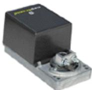
Приводы с угловым перемещением легко монтируются на валу воздушной заслонки или шарового клапана, имеют внешнюю кнопку для ручной настройки механизма привода, индикатор положения и перемещаемые упоры для настройки угла поворота. Приводы выпускаются с возвратной пружиной и без нее, напряжение питания 24V ac/dc или 115/230Vac.
