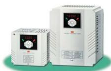
Частотные преобразователи LS Industrial Systems предназначены для регулирования скорости вращения электродвигателей в широком диапазоне путем изменения частоты питающего напряжения. Преобразователи имеют дисплей, клавиатуру, аналоговые, дискретные входы, цифровой интерфейс Modbus RTU.
