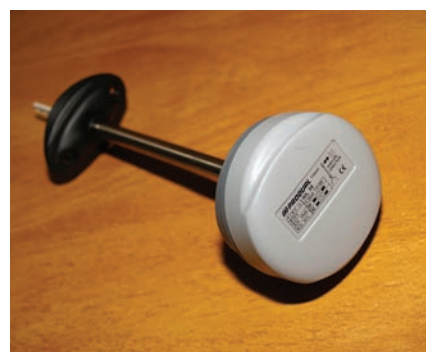
Рис. 3. Датчик температуры и скорости воздуха для воздухопроводов
