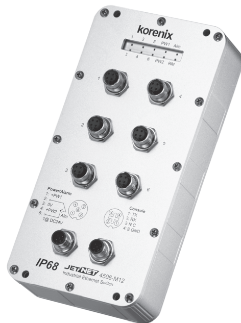
Рис. 4. JetNet 4506-M12: управляемый коммутатор, IP68, 2x(12–48) VDC, (от -25 до +70 °С)
