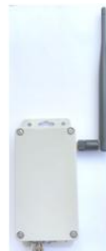
Специализированное конечное устройство (узел) LoRaWAN для мониторинга и управления насосной станцией
