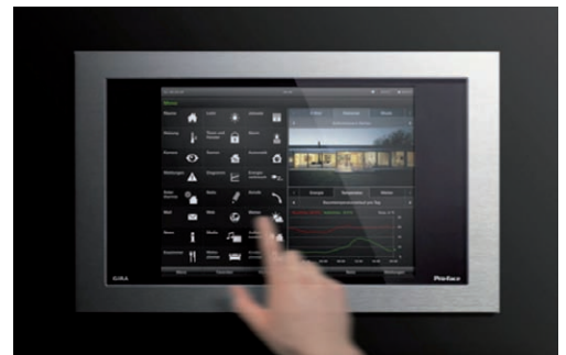
Функція централізованого управління інтегрованої системи надає можливість управління всіма системами в будівлі з одного переносного пульта чи сенсорної панелі
