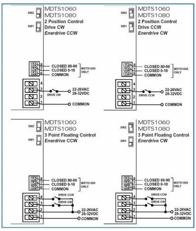
SW2 управляет направлением **Enerdrive**. Для работы **Enerdrive** в направлении CW обратитесь см. изображение положения выключателя **Enerdrive cw**; для работы в направлении CCW обратитесь к изображению положения выключателя **Enerdrive ccw**.
