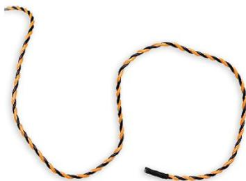
Кабельный сенсор Sontay WD-CS состоит из двух проводников со специальным антикоррозийным покрытием, закрепленных между сплетенными изолирующими элементами. Сенсоры обычно устанавливаются на полу контролируемого помещения в местах предполагаемого появления воды и обеспечивают контроль воды по всей длине кабеля. Sontay выпускает сенсоры длиной от 2м до
