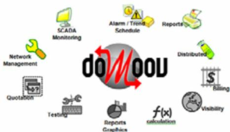
DoMooV - интегрированная программная платформа с набором открытых протоколов для систем автоматизации зданий: BACnet (ISO/IEC 16484-5), LonWorks (ISO/IEC 14908), KNX (ISO/IEC 14543), M-Bus (EN 13757), OPC и Modbus.
