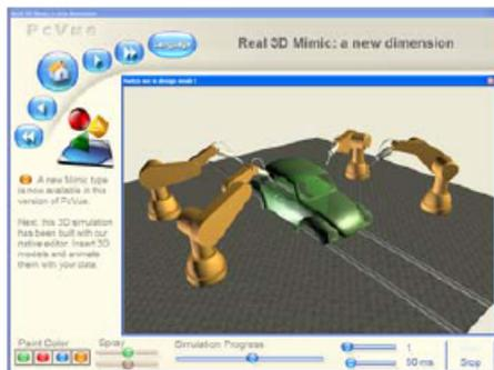
SCADA система PcVue разработана компанией ARC Informatique (Франция), имеет встроенный коммуникационный сервер LonWorks, обеспечивает поддержку многих других коммуникационных протоколов, механизмов DDE и OPC, 3-D анимации, WEB-сервисов. Она предназначена для широкого спектра приложений, в том числе, для систем управления зданиями (BMS), АСУ ТП, интеграции с системами класса MES, EAM.
