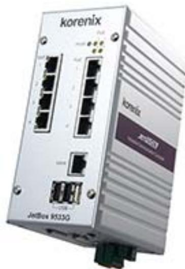
**JetNet** – ряд промышленных управляемых/ неуправляемых Ethernet-коммутаторов, в том числе с технологией резервирования соединения Rapid Super Ring (время восстановления соединения 0...5 мсек);
