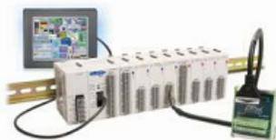
Новое семейство недорогих программируемых логических контроллеров (PLC) **CLICK** являются практичным решением в компактном исполнении с возможностью расширения (до 142 входов/выходов) и бесплатным программным обеспечением. Процессорные модули имеют до 3-х портов RS232/485. Применяются для управления станками, прессами, насосами, подъемниками и другим оборудованием.
