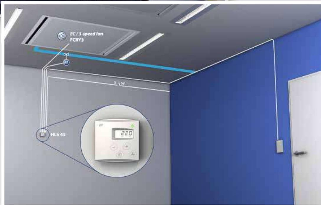
HLS 45 можно использовать для регулировки фанкойлов с двухтрубными системами для переключения на летний и зимний режимы работы. Контроллер также подходит для управления полами с подогревом с предельной температурой возвратной воды. HLS 45 можно подключить к Modbus RTU.
