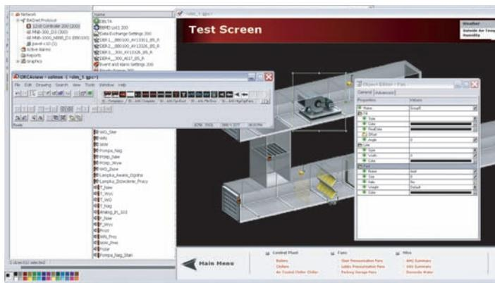
Рис. 6. Свойства графических компонентов позволяют легко подключить к ним объекты и отобразить состояние оборудования
