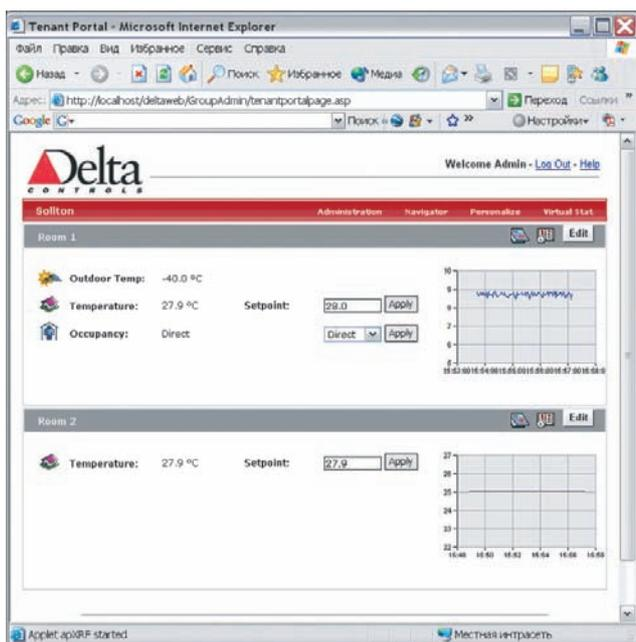
Рис. 8. Благодаря специальному веб-компоненту Tenant Portal (Портал Арендатора) арендатор/жильец имеет возможность контроля и управления своими инженерными системами.
